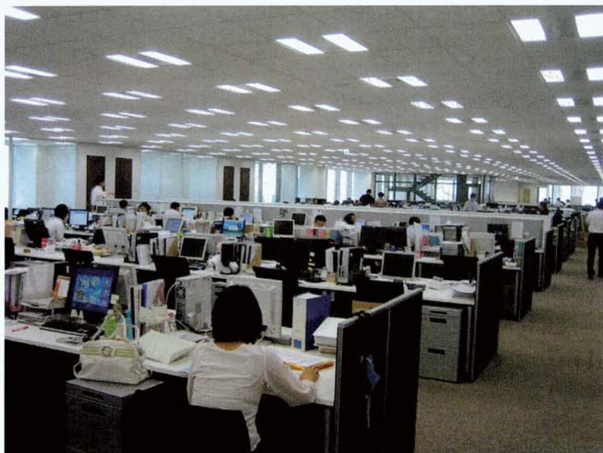
4人分を1ユニットとし、業務・機能に合わせた用途転換が容易なユニバーサルプランを採用した執務室。スペースの有効活用と業務効率向上を図る。
